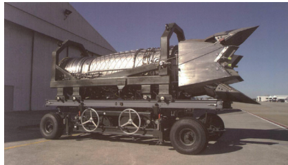
(c) 安装车图 2 (发动机及运输装置-安装架安装状态)
