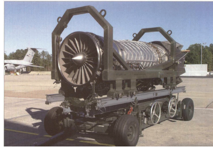
(b) 安装车图 1 (发动机及运输装置-安装架安装状态)
